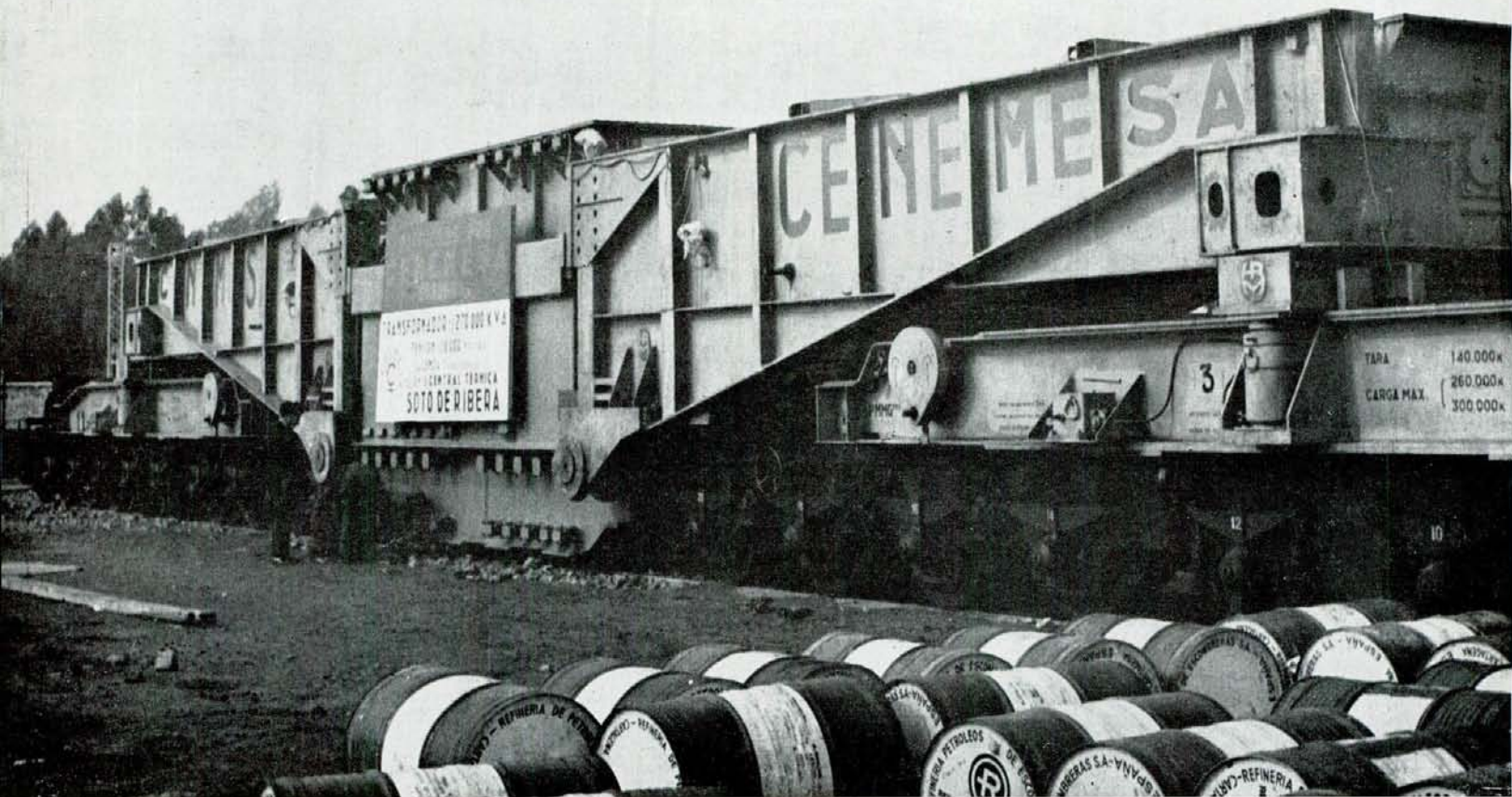
Transformador trifásico elevador 270 MVA. en orden de transporte autoportado sobre vagón Schenabel, propiedad de CENEMESA.
